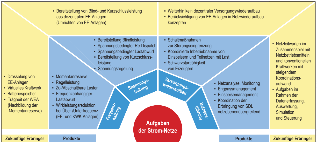
Abb. 6: Aufgaben der Strom-Netze bei dezentraler Energieversorgung
